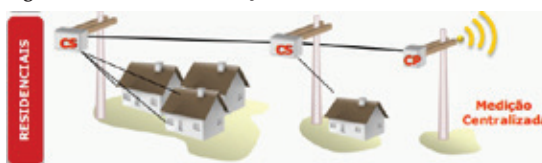
Figura 4: Sistema de Medição Centralizada (RIVERA, 2013)
