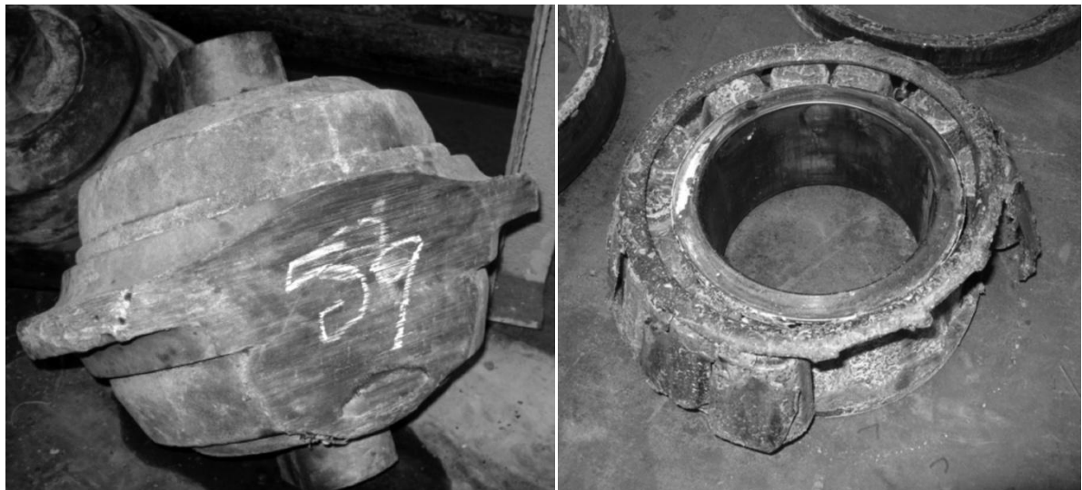
Figura 52: Disco cortador bloqueado (Sem rotação) e Rolamento quebrado (fonte: < http://www.unitracc.com/ >).
