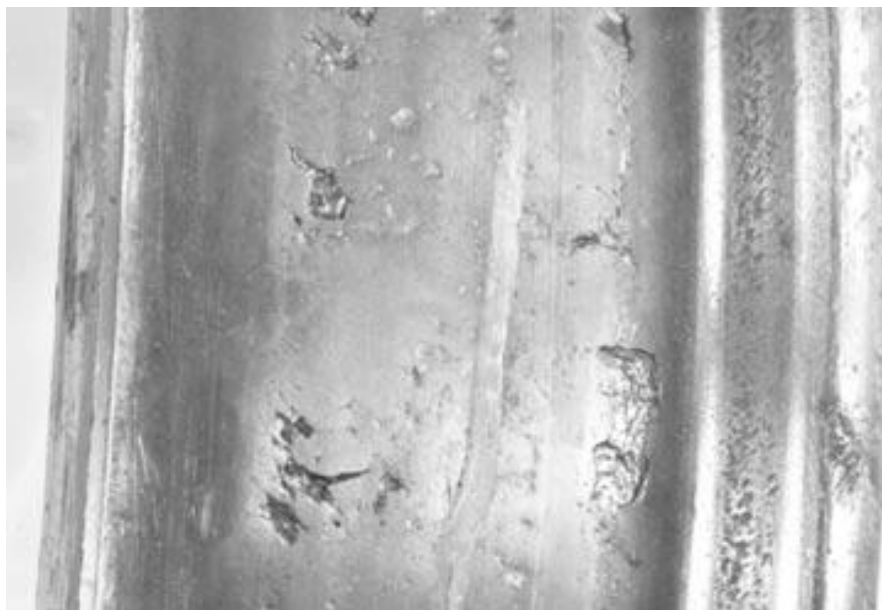
Figura 34: Desprendimento de material da superfície[19].
