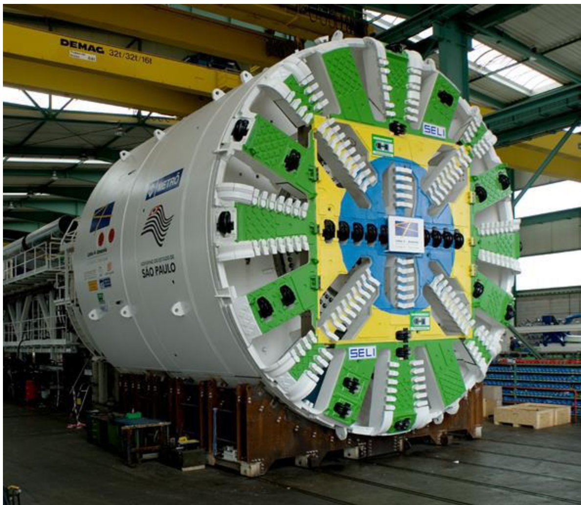
Figura 11: EPB utilizada na Linha 4 do metrô de São Paulo [1].
