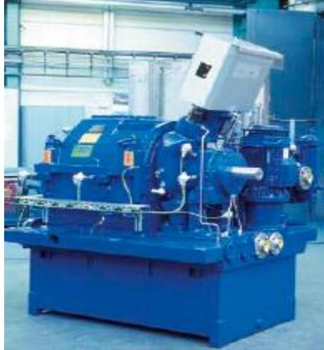
**Figura 25:** Acoplador de velocidade variável modelo R17K450M da VOITH. [18]
